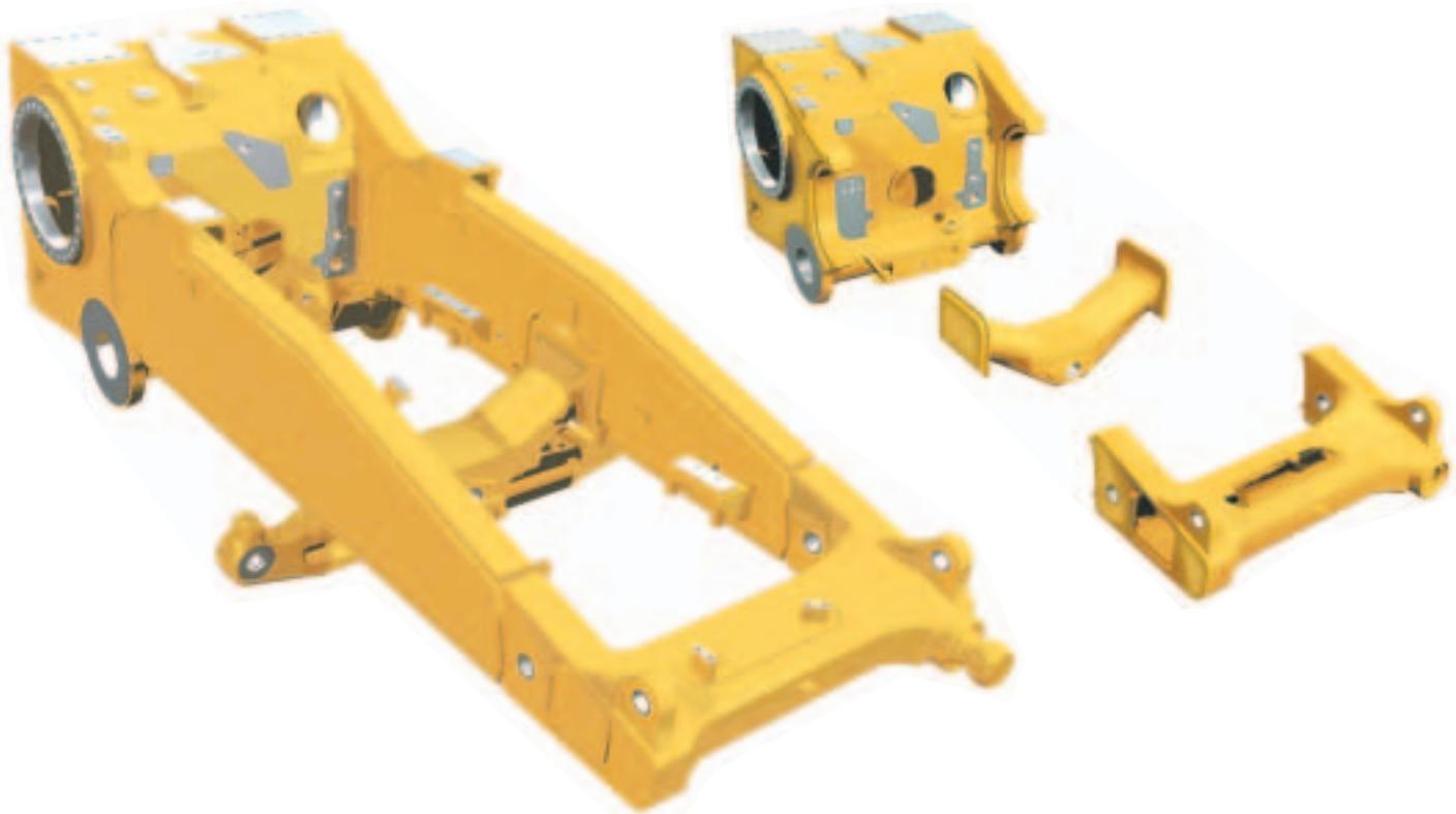
**Основная рама.** Предназначена для поглощения значительных ударных нагрузок и скручивающих усилий.
