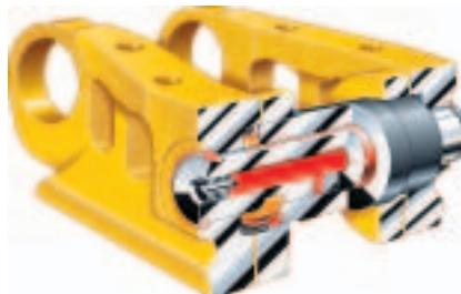
**Траковая лента с жесткой фиксацией пальцев.** Рассчитана на высокие ударные и силовые нагрузки, испытываемые при выполнении работ, связанных с разработкой карьеров, строительством крупных сооружений, разрушением зданий и утилизацией отходов. Траковая лента с принудительной фиксацией пальцев является эксклюзивной разработкой компании Caterpillar, которая предусматривает жесткое соединение гусеничной цепи с пальцами.
