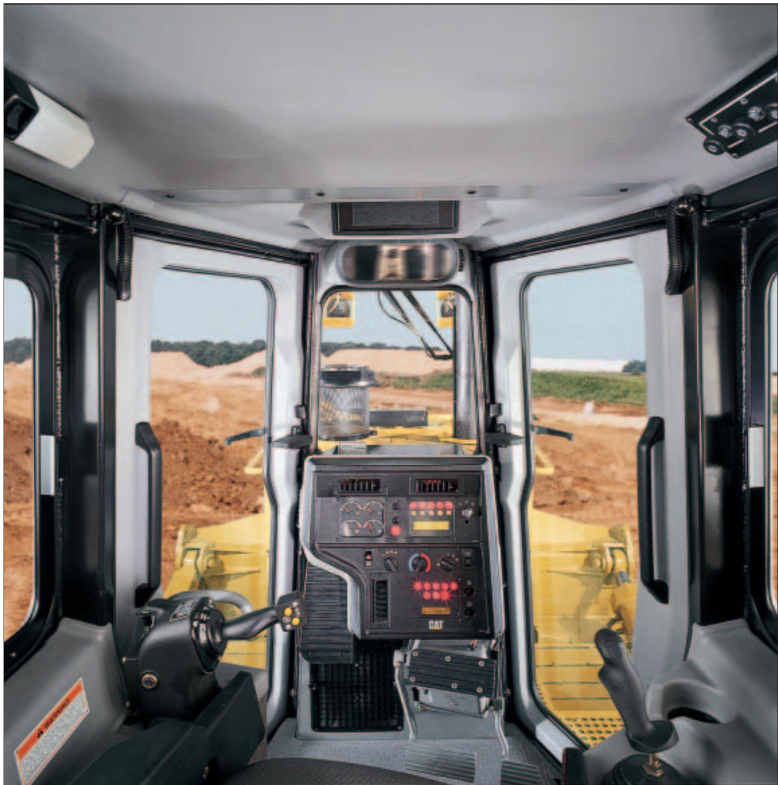
**Система контроля, разработанная компанией Caterpillar.** Постоянно информирует оператора о текущем состоянии систем машины, а также регистрирует в памяти повышенные и пониженные показания приборов для диагностики и управления работой ходовой части. Система контроля включает в себя стрелочные указатели температуры охлаждающей жидкости двигателя, масла гидравлической системы и масла силовой передачи, а также уровня топлива в баке.
