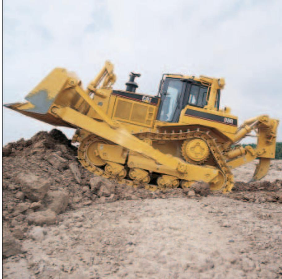
ким образом, необходимой гидравлической мощностью постоянно и одновременно обеспечиваются как система управления поворотом, так и рабочее орудие машины.
