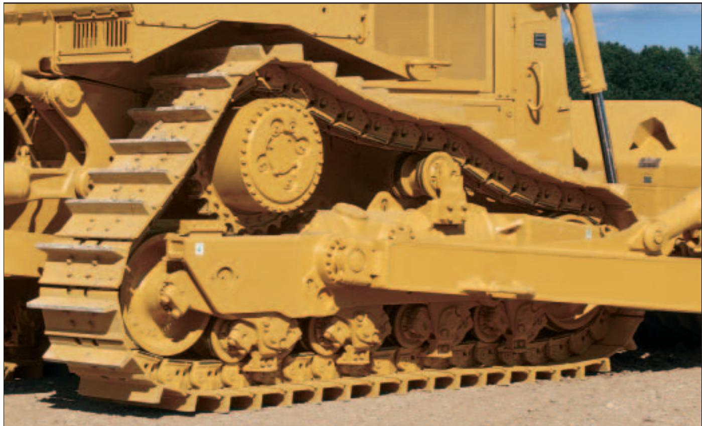
**Подвеска тележки.** Компенсирует неровности рельефа поверхности, обеспечивая более полный контакт гусеничной ленты с грунтом, особенно с мерзлым и со скальной породой. Как результат - лучше сцепление с грунтом, меньше пробуксовка, лучше балансировка машины и плавнее ее ход.
