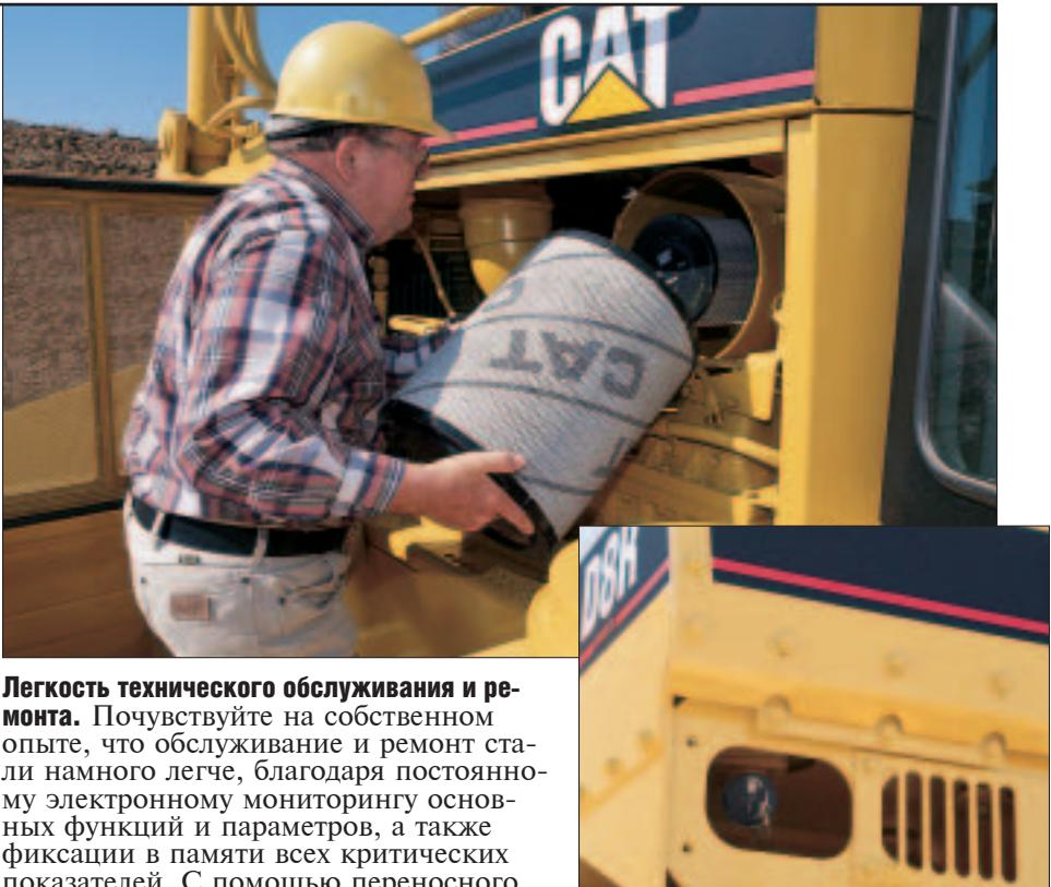
**Легкость технического обслуживания и ремонта.** Почувствуйте на собственном опыте, что обслуживание и ремонт стали намного легче, благодаря постоянно му электронному мониторингу основных функций и параметров, а также фиксации в памяти всех критических показателей. С помощью переносного компьютера, оборудованного программой "Электронный техник", можно быстро провести диагностику систем машины.
