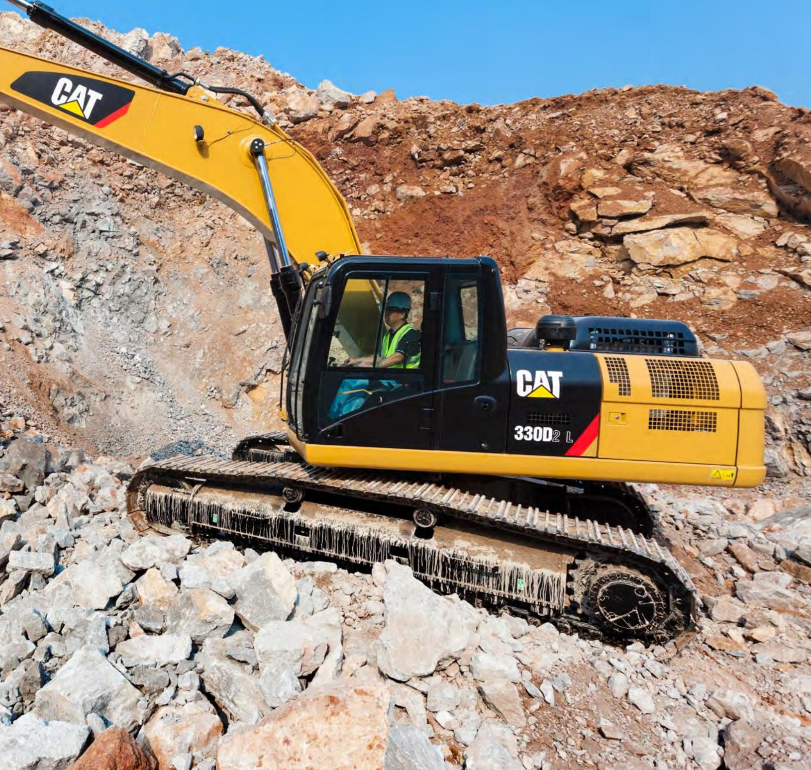
Машина 330D2 L оснащена рядом новых технологий и функций, позволяющих получить максимум от вашего оборудования. Изохронное управление частотой вращения коленчатого вала двигателя, новая система фильтрации топлива и встроенный экономичный режим обеспечивают сокращение расхода топлива. Вентилятор с частотно-регулируемым приводом с вязкостной муфтой обеспечивает производительность, эффективность и безопасность.
