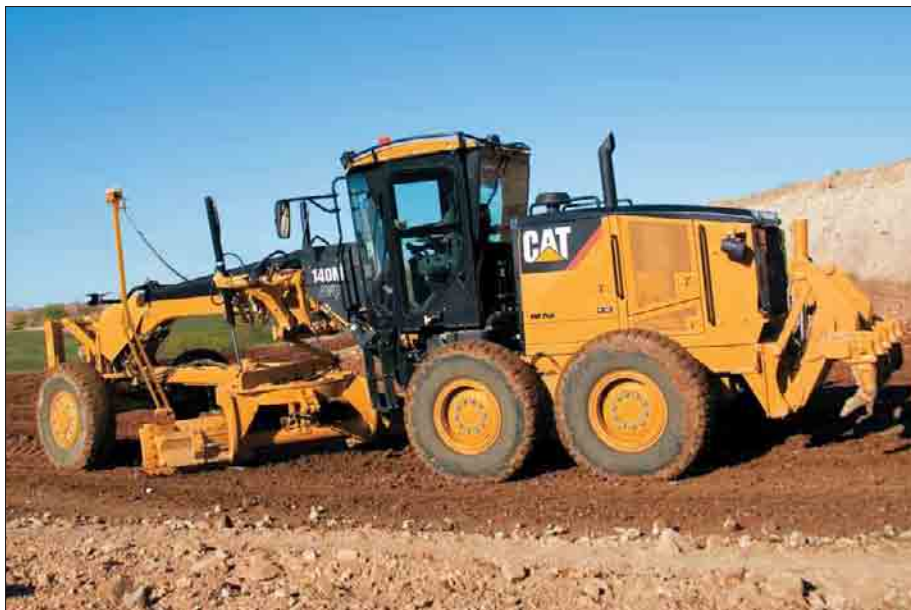
Автогрейдер Caterpillar 140M с системой AccuGrade™
